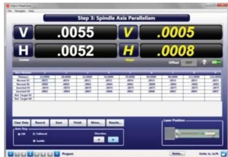
contropunta e la torretta viaggiano su guide separate. Per raccogliere i dati il sensore è montato sulla torretta o sulla contropunta e spostato lungo la guida per ogni punto. Premere la barra spazio per raccogliere I dati quando arrivati al termine della corsa premere il bottone Results per visualizzare i dati di allineamento.
